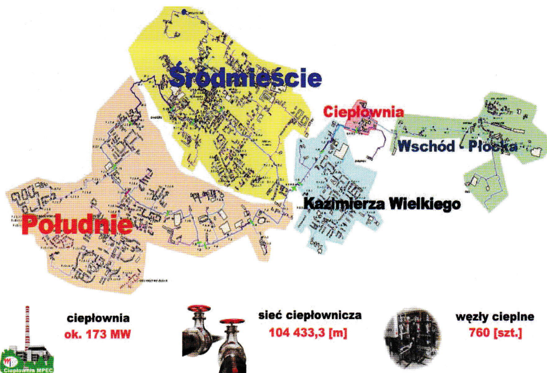
RYS. 1 Infrastruktura ciepłownicza MPEC we Włocławku (Źródło: MPEC-Włocławek)
