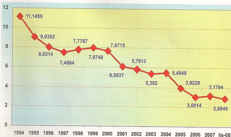
Rys. 5. Wskaźnik zużycia energii elektrycznej w odniesieniu do produkcji ciepła w [kWh/GJ] Źródło: opracowanie własne
